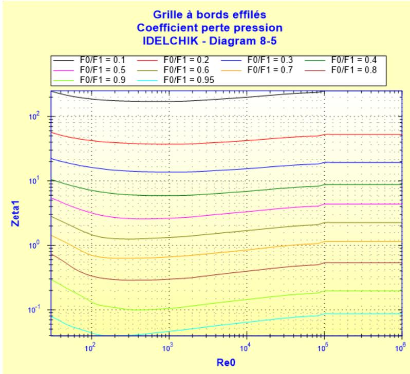
Coefficient de perte de pression (basé sur la vitesse moyenne dans le tuyau) :
