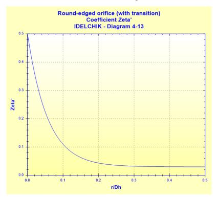
Coefficient de perte de pression (basé sur la vitesse dans le grand tuyau) :
