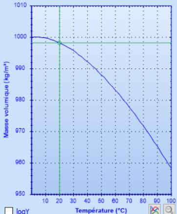
Masse volumique (kg/m<sup>3</sup>) vs Température (°C)
