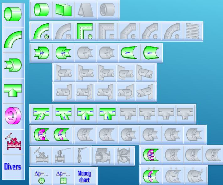
La barre verticale des composants permet de sélectionner une famille de composants (tuyaux rectilignes, coudes, changements de section, bifurcations, diaphragmes d'équilibrage et de mesure, vannes, ...)
