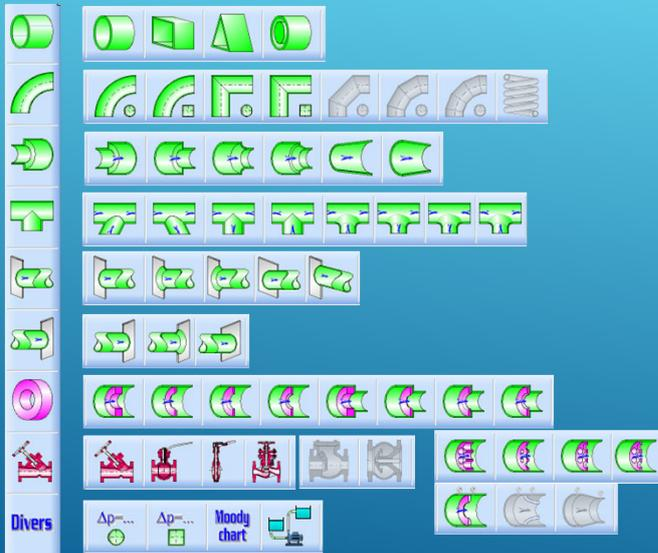
La barre verticale des composants permet de sélectionner une famille de composants (tuyaux rectilignes, coudes, changements de section, bifurcations, entrées et sorties de circuit, diaphragmes d'équilibrage et de mesure, vannes, ...)
